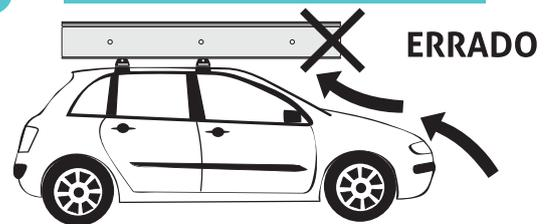
Cargas com grande área, como colchões, chapas de compensado, MDF, pranchas, longboard e stand up, etc... Deve-se tomar cuidado com a pressão aerodinâmica exercida à frente do pára-brisa, que levanta o conjunto voando fora. Para isto, devemos **colocar cargas com grande área para trás**, e não ultrapassar 80 km/h.
